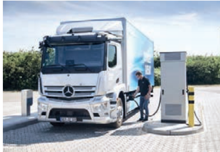
O eActros LongHaul tem autonomia de cerca de 500 quilômetros com uma carga de bateria
