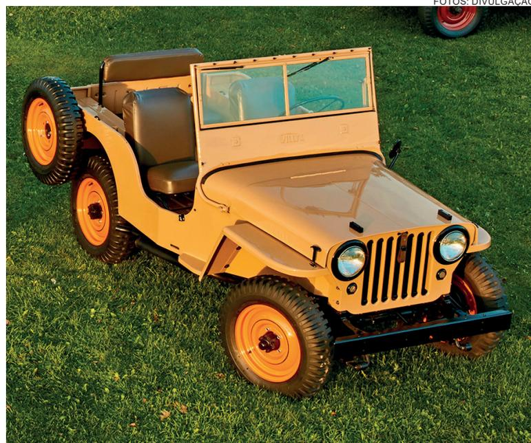
linhagem, o CJ-3A, que trouxe melhorias estruturais como para-brisas de peça única e eixo traseiro reforçado, mantendo o motor original, de quatro cilindros com cabeçote em L. O CJ-3A chegou com melhorias estruturais, seguido pelo CJ-3B em 1953, que passou a ser montado no Brasil, em São Bernardo do Campo, pela Willys-Overland do Brasil.
