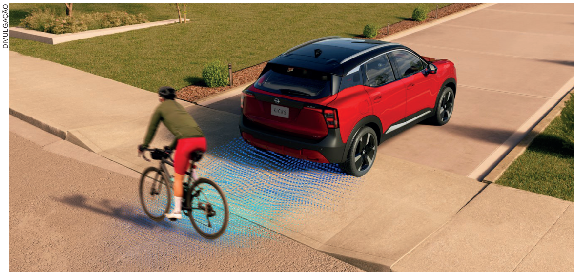
Ao sair de uma garagem, o sensor de presença avisa o carro que há um ciclista passando
