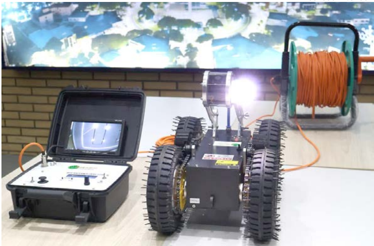
EQUIPADO com câmera, iluminação e transmissão de imagens em tempo real, o robô indica com precisão onde uma intervenção será necessária
