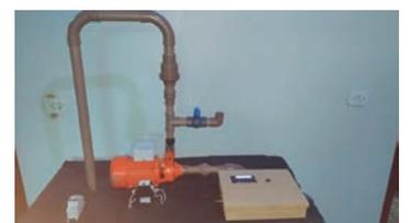
campo. Sem o processo de escorva, essas máquinas não funcionam adequadamente, provocando vários transtornos à população e à produção agrícola, além de um grande prejuízo financeiro. Isso justifica a inovação por um sensor que possibilite o desligamento automático do conjunto motobomba, quando não há escorva no processo.
