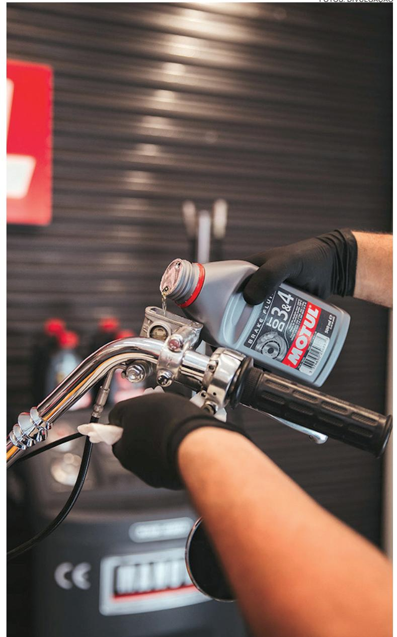
É comum que o nível do fluido de freio diminua com o desgaste das pastilhas e discos.
