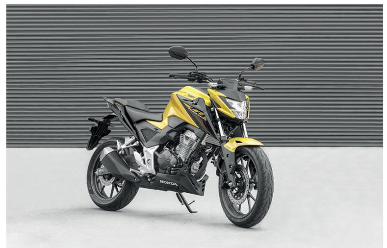
equipava sua antecessora. O ganho de capacidade cúbica – que passou de 249,5 cm<sup>3</sup> para 293,5 cm<sup>3</sup> – foi obtido mediante o aumento do diâmetro do cilindro, que passou de 71 para 77 mm, sendo mantido o curso de 63 mm. Importante lembrar que tal opção permitiu o aperfeiçoamento do cabeçote de quatro válvulas e consequente ganho para o sistema de alimentação e exaustão do motor.
