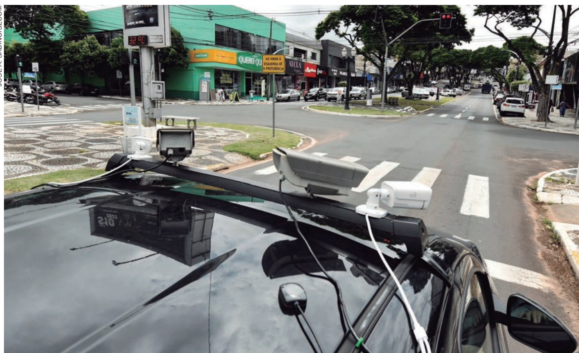
O sistema fiscaliza o tempo dos veículos por meio de leitura de placas por um equipamento instalado em um veículo que circula pelo trajeto com frequência
