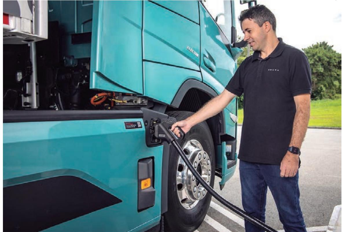
de PBTC (Peso Bruto Total Combinado) de até 44 toneladas. Ele pode ser equipado com três motores elétricos e até seis baterias (540 kWh).
